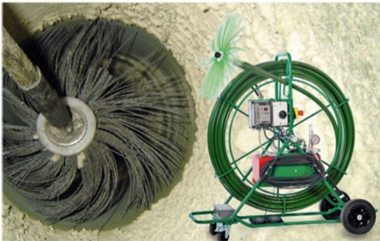
Rotierende Bürsten lösen Verschmutzungen
